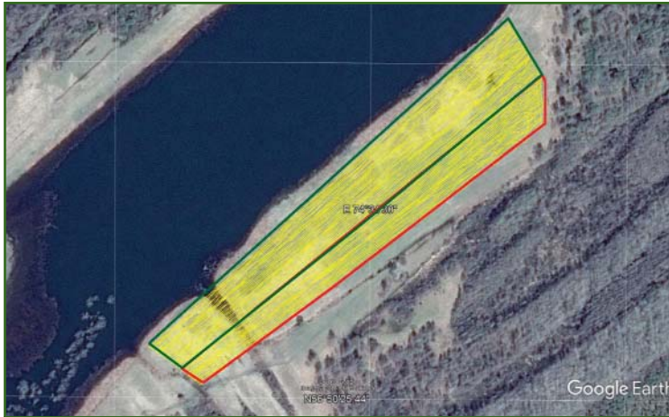
Рис. 2 Границы участков аэромагнитной съемки: с высоты 1,5–2 м — контур красного цвета, с высоты 5–5,5 м — контур зеленого цвета
